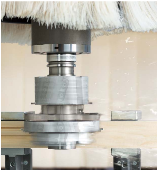
Abbildung 1 OERTLI Werkzeug mit CAT Schneidensitz im Einsatz, bis 120 m/s.
